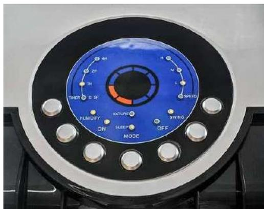
**ON/OFF.** Нажмите кнопку ON/OFF, чтобы включить устройство. Устройство начинает работать со средней скоростью и через 3 секунды переключается на меньшую скорость.
